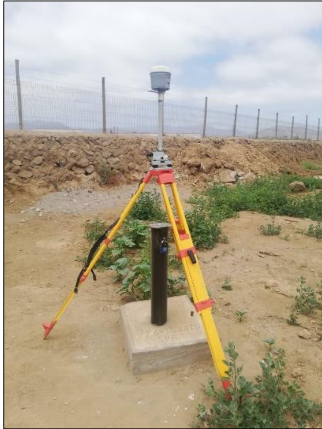
Figura 4-7: Proceso en Terreno Georreferenciación de sondaje DGA-INIA
