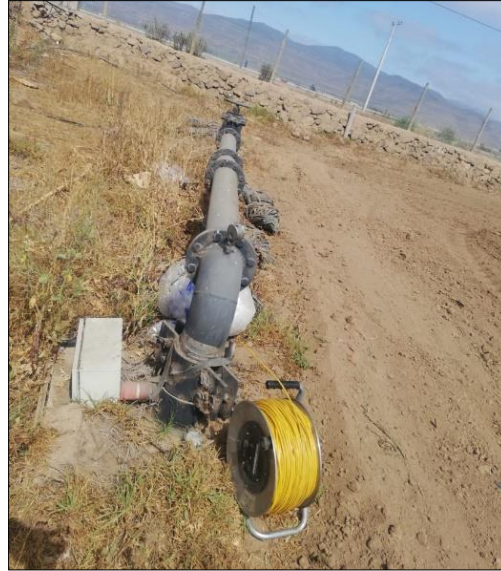
Figura 5-32: Medición de nivel freático P6 (ubicado en terreno de INIA)
