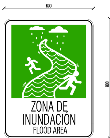
Figura 13.10 Letrero tipo zona de inundación
