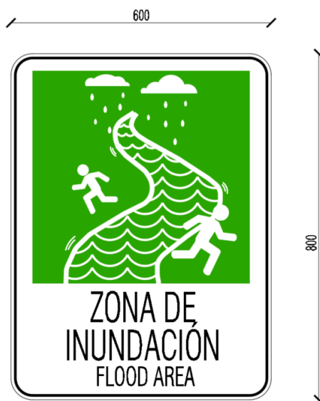
Figura 13.4 Letrero tipo zona de inundación
