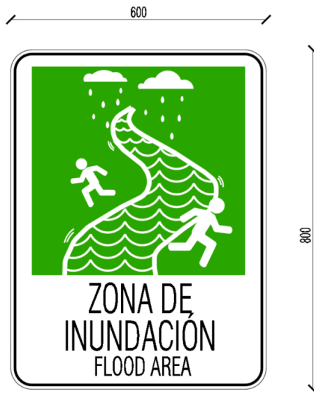
Figura 13.4 Letrero tipo zona de inundación
