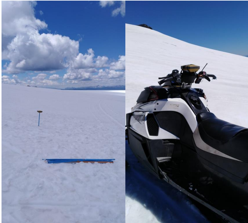
Figura A I-E. Levantamiento GNSS. Izq. Medición de baliza. Der. Medición en modo cinemático.
