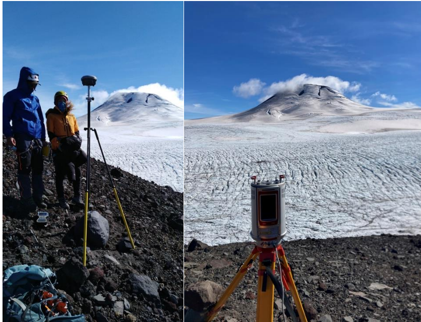
Figura A I-F. Levantamiento LiDAR terrestre en el glaciar Sur Oriental del Volcán Mocho.
