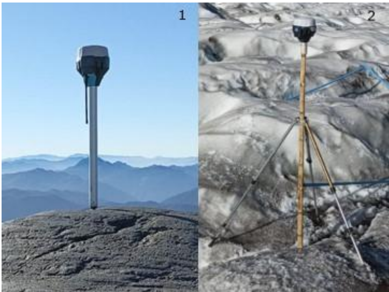
Figura 3.5-A. 1. Instalación de GPS base BMCH. 2. Instalación de GPS en balizas.
