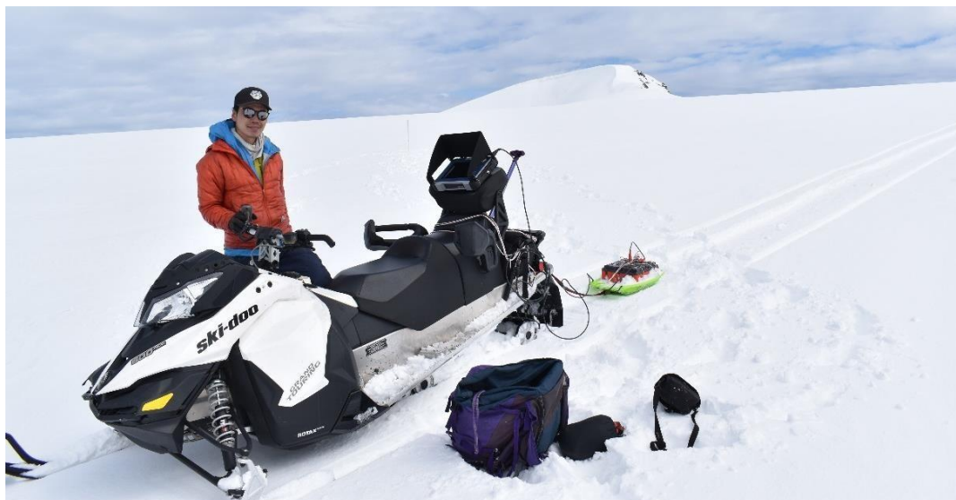
Figura A I-A. Levantamiento con GPR de 350 MHz.
