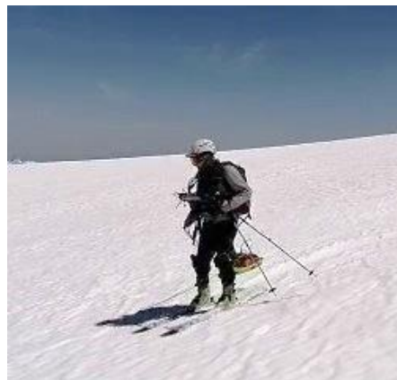
Figura 3.2.3-A. Sistema de radar de la marca GSSI con antena de 350 MHz montada en trineo de plástico.
