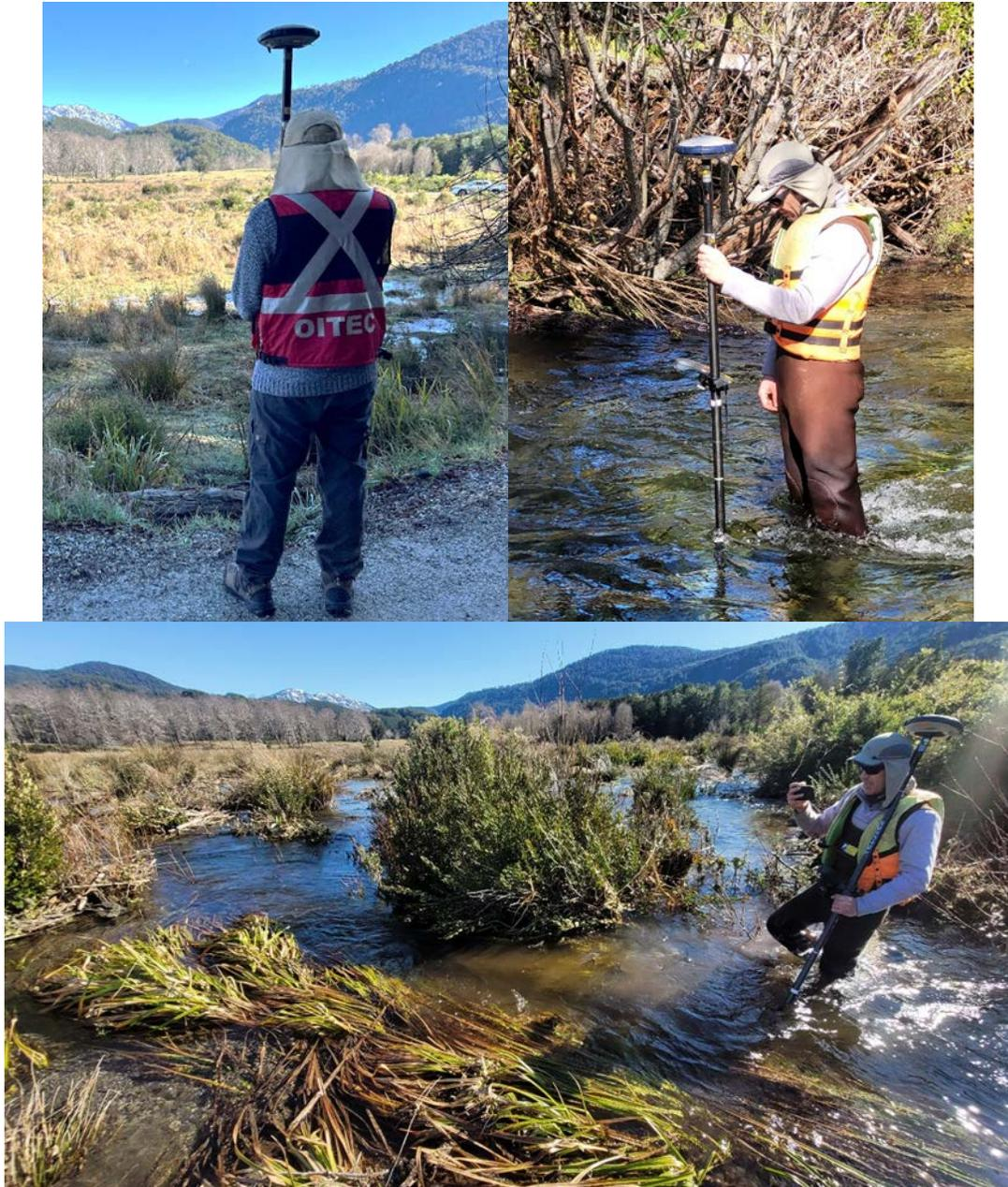
*Figura 12: Levantamiento de puntos batimétricos mediante GPS geodésico.*
