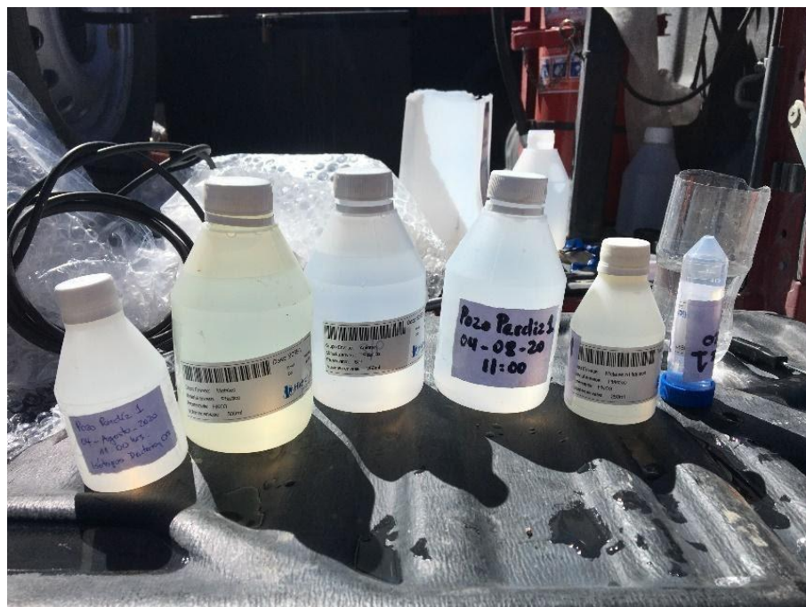
Figura 3-8: Toma de muestras para análisis hidroquímico e isotópico, pozo Cerro Pabellón, cordillera región de Antofagasta.
