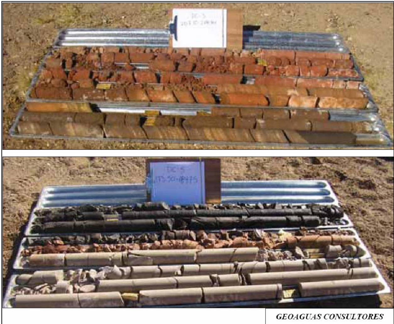
Figura 2-3 Fotografías de muestras de testigos de los pozos PCDC-3 (arriba) y PADC-5 (abajo), para los tramos 207.10-219.74 m y 173.5-184.75 m, respectivamente. En estos tramos se observan sectores, muy fracturados y niveles sedimentarios, que presentan condiciones preferenciales para los flujos subterráneos.
