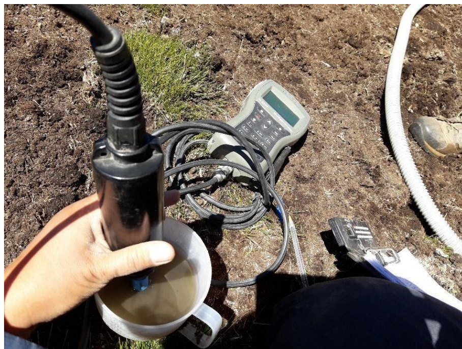
Figura 3-7: Medición de parámetros fisicoquímicos en puntera de la vega Guanaco, cordillera de la región de Atacama.
