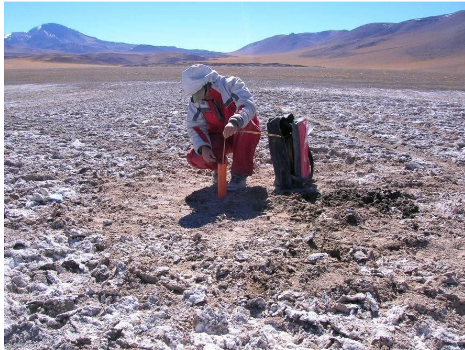
Figura 3-5: Medición de nivel estático puntera en el salar de Aguas Calientes Sur.
