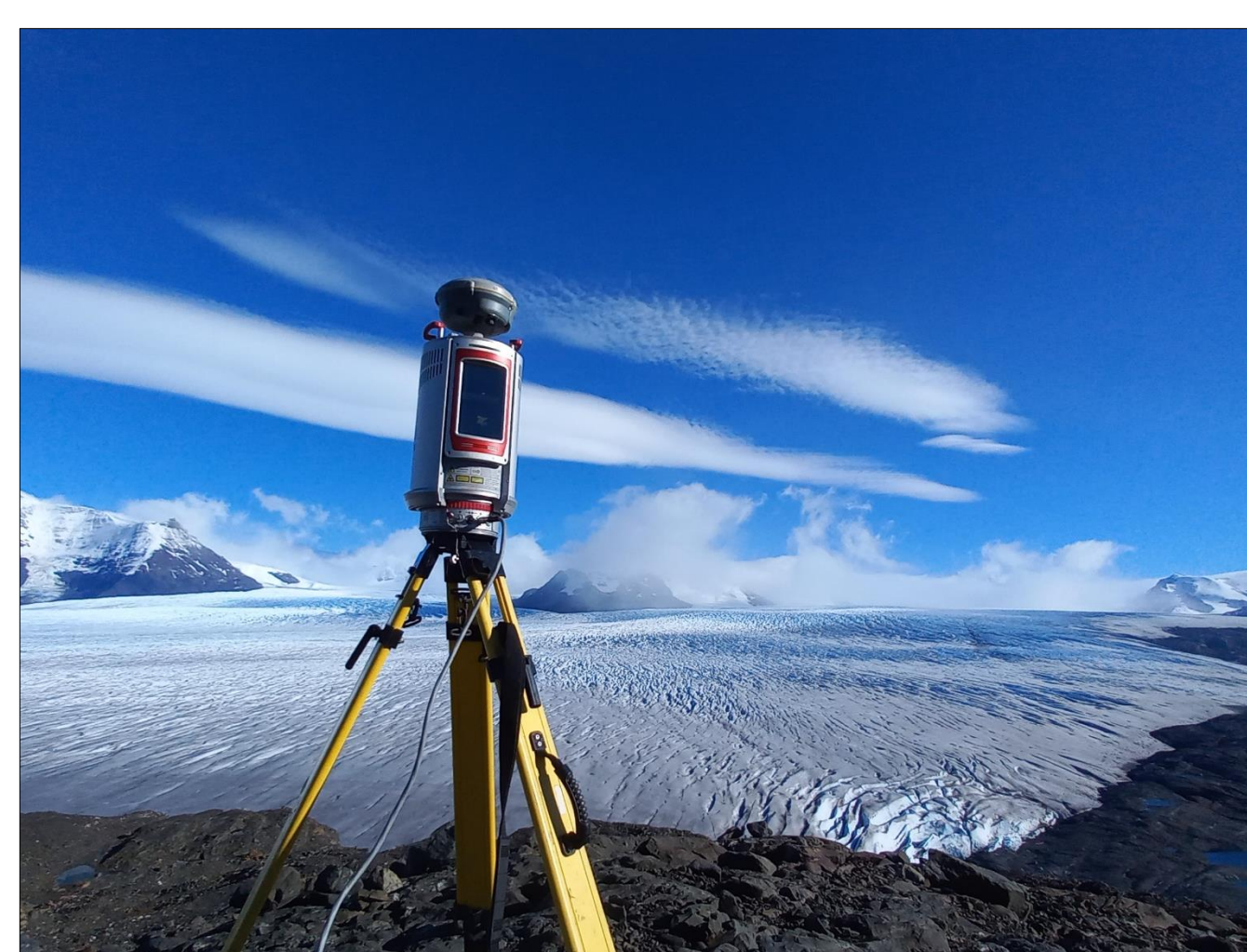
FIGURA 1. Levantamiento geodésico con instrumento LiDAR terrestre.
