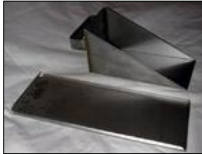
Figura 11.4. Cortador de nieve en forma de cuña (1000 cm 3 ).
