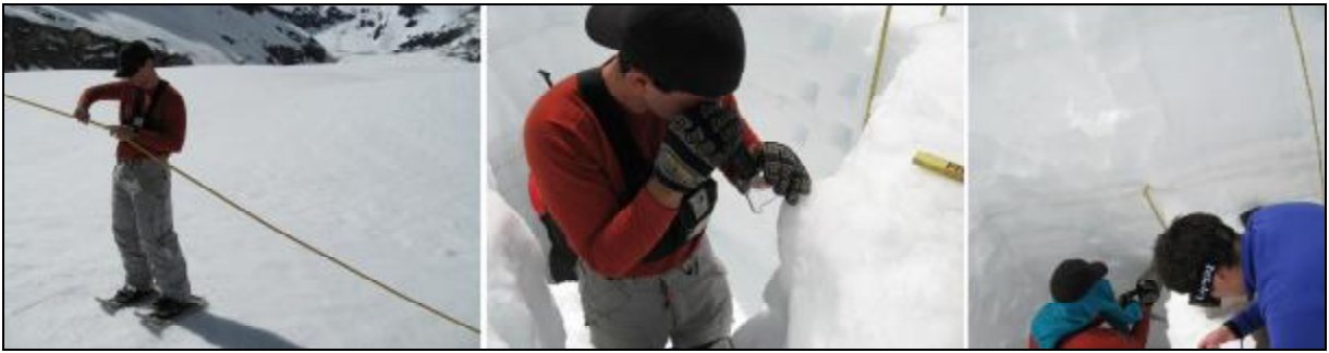
Figura 9.11. Dr. Molotch guía las mediciones realizadas al manto de nieve sobre el glaciar Juncal Norte. (Izq.) Mediciones de profundidad. (Centro) Mediciones del grano de nieve. (Der.) Mediciones de densidad.
