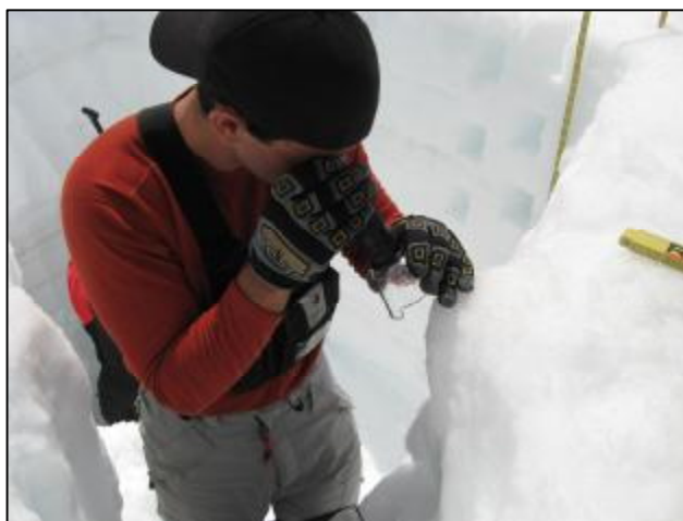
Figura 11.6. Observación de los granos de nieve por medio de un microscopio para la nieve.
