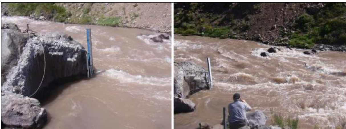
Figura 9.17. Estación fluviométrica Juncal en Juncal (Izq.) Regla limnimétrica y roca de apoyo. (Der.) Flujo en la estación fluviométrica.
