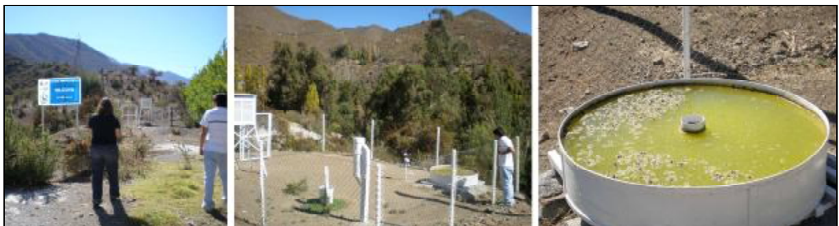
Figura 9.2. Estación meteorológica Vilcuya. (Der.) Evaporímetro de bandeja con suciedad.
