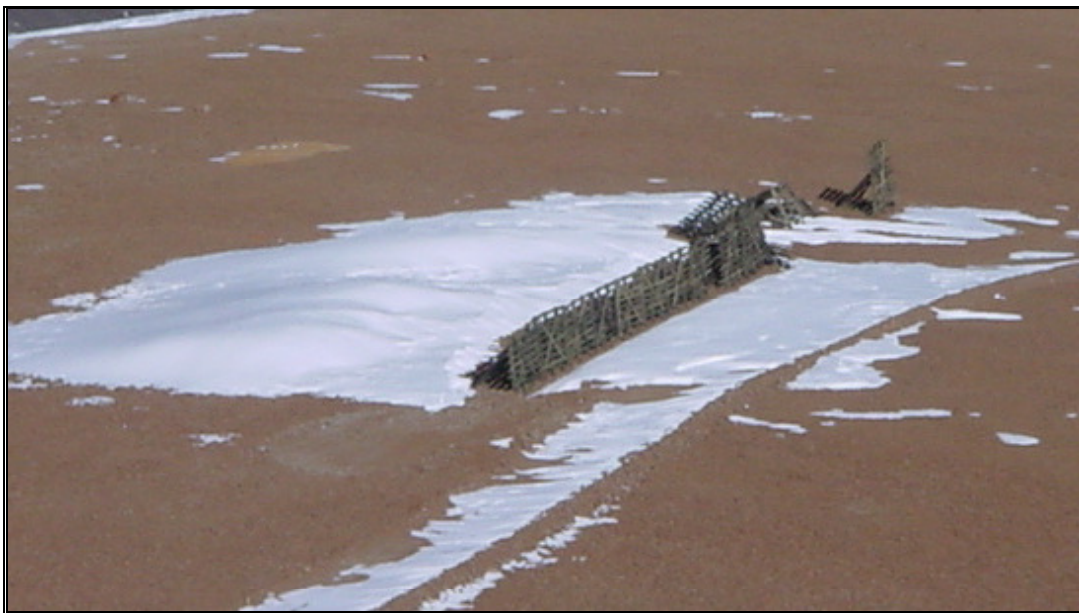
Fig. 3.1.1.1-B. Valla para producir una acumulación artificial de nieve; experiencias en Chile. Viento de derecha a izquierda sobre la valla. La acumulación de nieve delante y detrás de la valla se denomina vestigio anterior y vestigio posterior de nieve.
