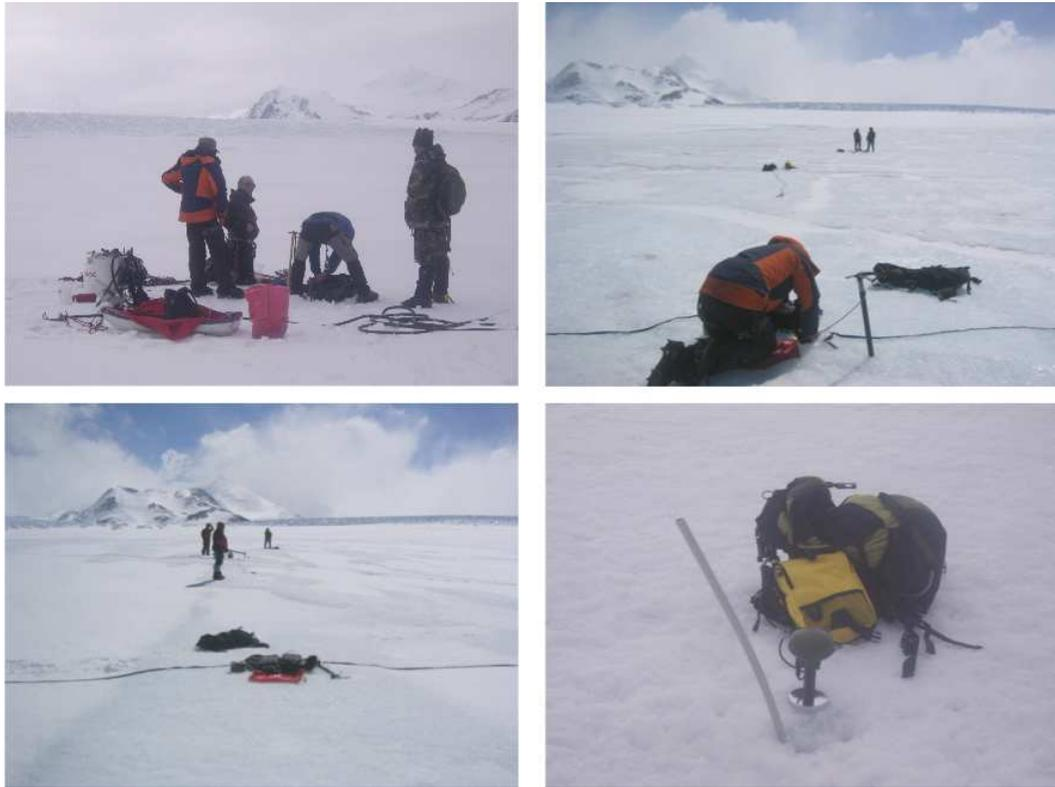
Figura 3.15: Instalación de balizas, mediciones de radio eco sondaje sobre la zona de ablación del glaciar Tyndall.
