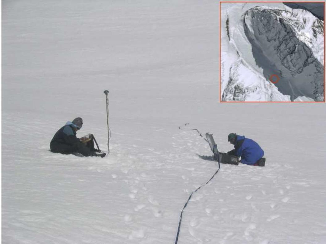
Figura 3.9: Equipo GPS móvil junto al sistema de radar sobre el glaciar Juncal Norte.
