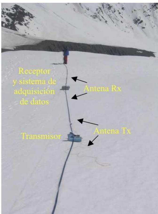
Figura 3.8: Sistema de radar desplegado sobre la superficie del glaciar Juncal Norte
