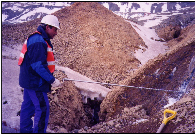
Fig.7.3.2-A. Explorando con taladro para hielo el borde de una grieta de tensión en un glaciar de roca en los Andes del centro de Chile. Hielo azul en el punto de inserción del taladro, cubierta tenue de detritos sobre el hielo.
