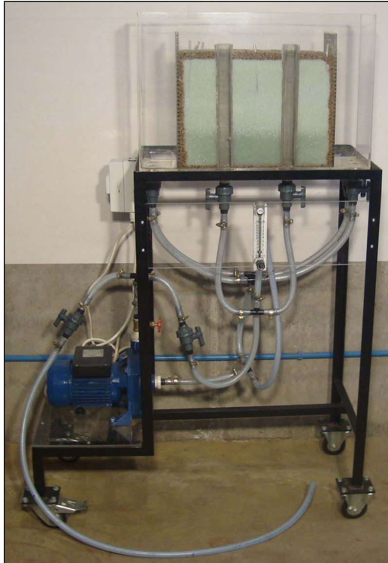
Figura 4.13. Modelo físico de aguas subterráneas terminado.
