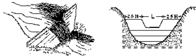
Ilustración 6-8 Vertedero Trapezoidal o Cipolletti
