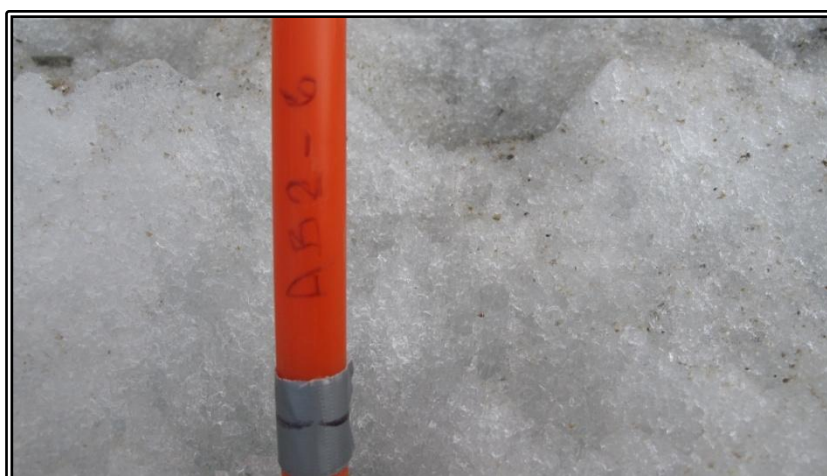
Figura 4.4.1.2-D. Baliza flexible de PVC, con marcas de identificación y nivel de la superficie del hielo. Corresponde a la baliza AB-2.
