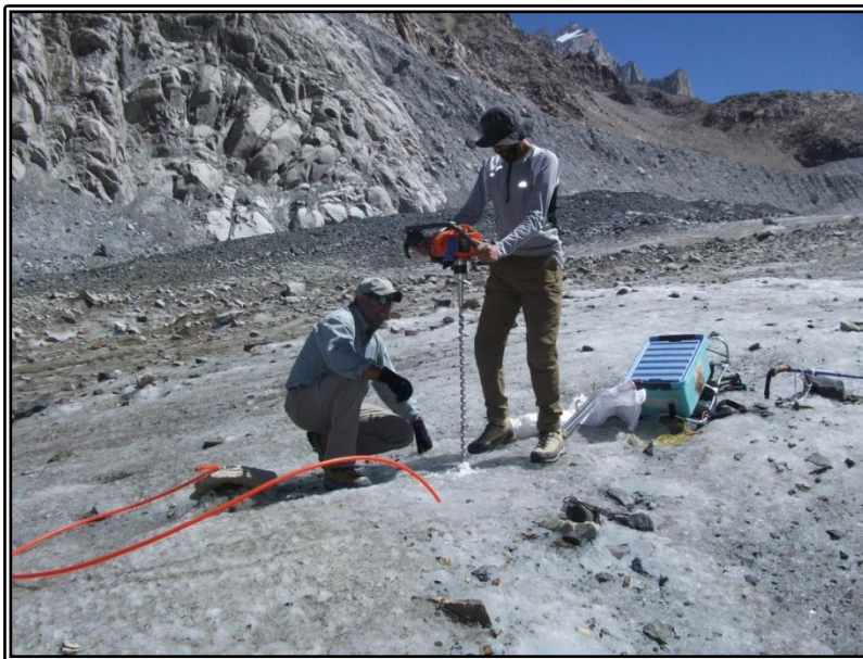
Figura 4.4.1.2-A. Taladro de perforación en hielo y baliza flexible de PVC.
