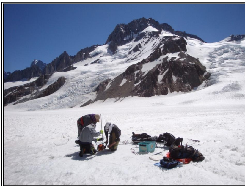
Figura 4.4.1.3-B. Trabajos de perforación del hielo con taladro mecánico en la cuenca Norte del glaciar Universidad.
