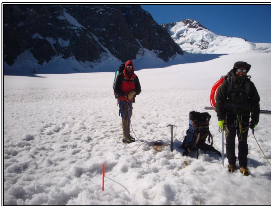
Figura 4.4.1.3-E. Baliza de ablación instalada en la zona alta de la cuenca Oeste del glaciar Universidad.
