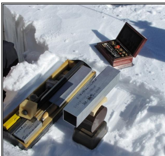
Figura 4.4.2.1-B. Tubos muestreadores, balanza y otros elementos del equipo para medir densidad de nieve en las paredes de un pozo.
