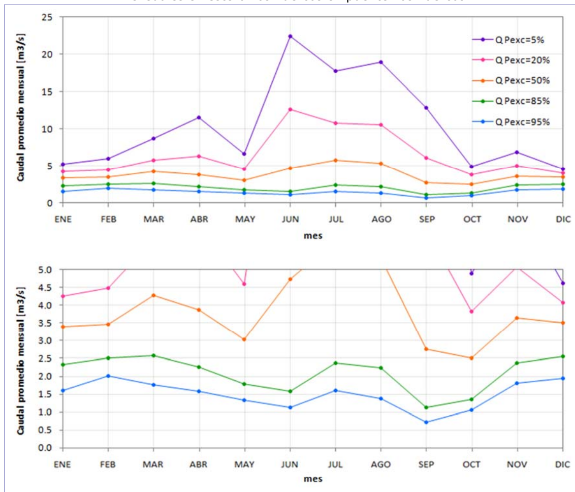
Figura III-2. Curva de variación estacional de caudales promedios mensuales en estero Los Puercos en puente Los Puercos
