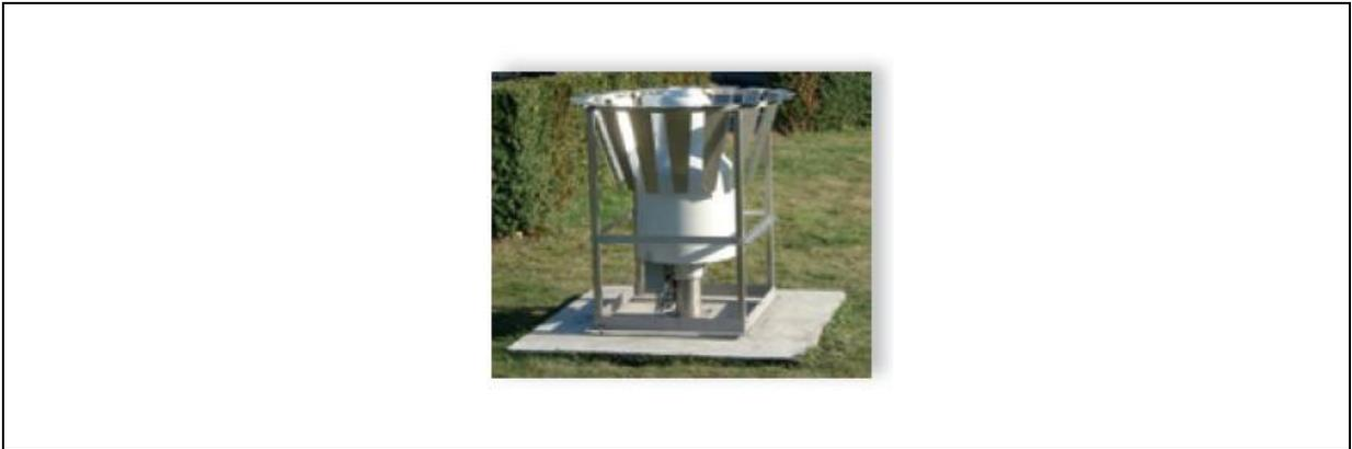
Figura 3-6: Protección para el viento en pluviómetro
