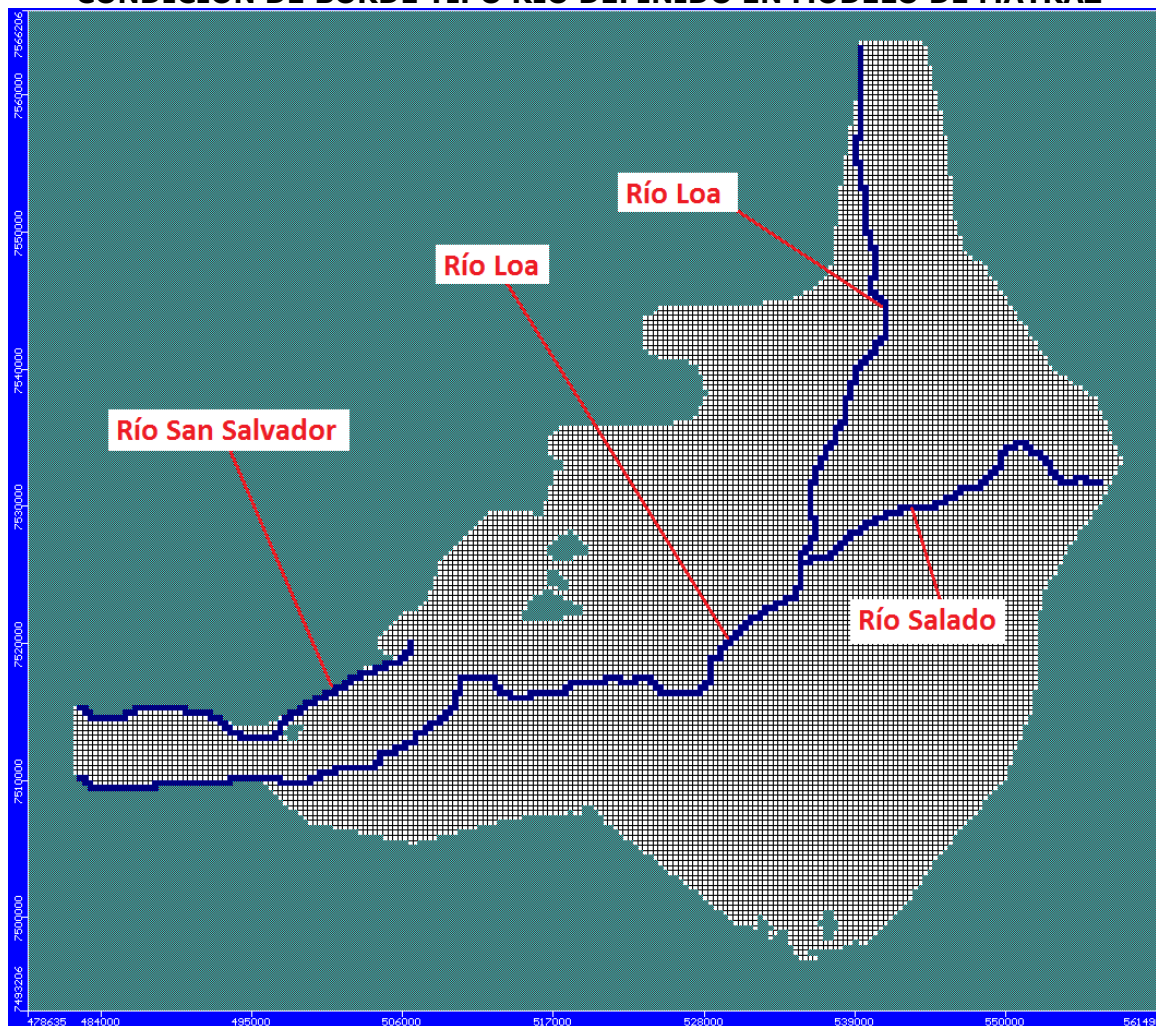
FIGURA 10.1-8 CONDICIÓN DE BORDE TIPO RÍO DEFINIDO EN MODELO DE MATRAZ
