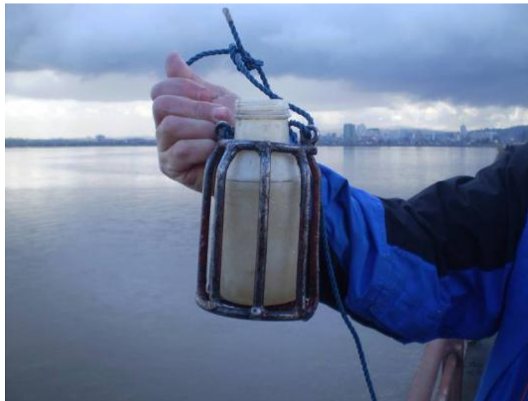
Figura 1. Canastillo y botella, muestreo en el río Biobío sector desembocadura. (Foto de Hernán Alcayaga).
