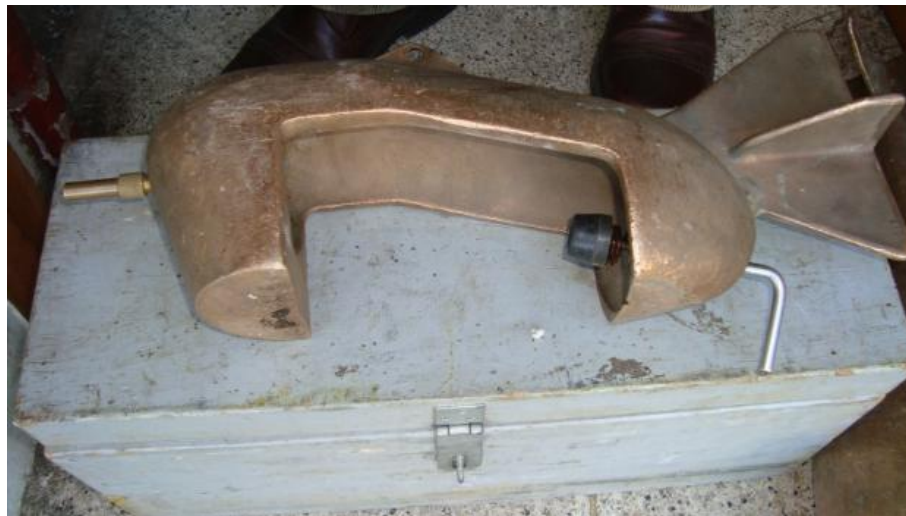
Figura 3. Muestreador tipo DH-59: DGA Ñuble. (Foto de Hernán Alcayaga)
