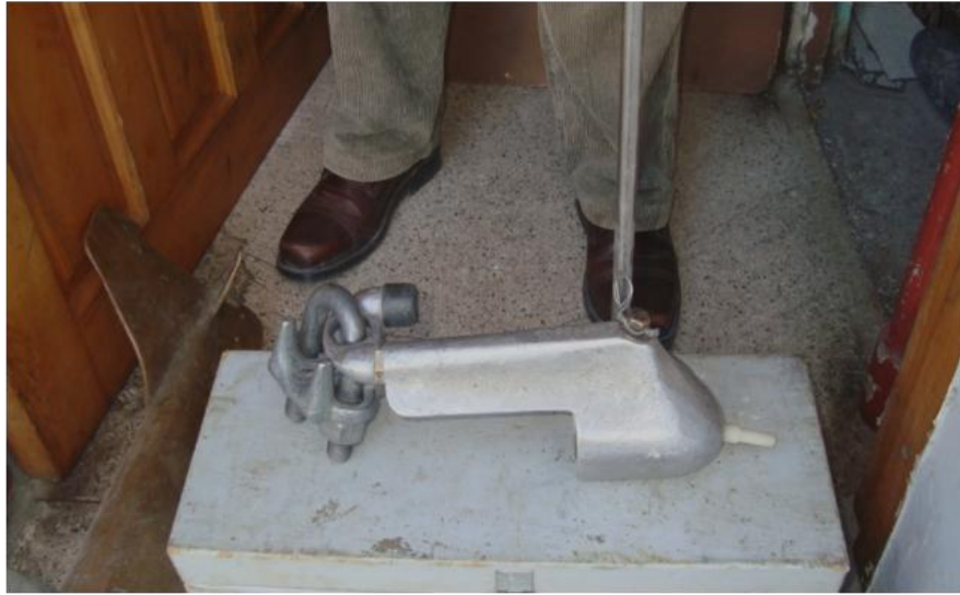
Figura 2. Muestreador tipo DH-48: DGA Ñuble. (Foto de Hernán Alcayaga)
