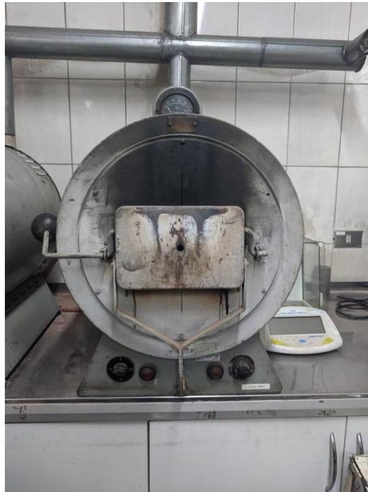
Figura 5. Mufla de calcinado del laboratorio de la red sedimentológica de la DGA y a la derecha balanza de precisión 0.0001 g. (Foto de Karina Soto Rivas).
