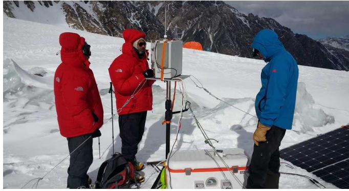
Figura 8: Equipo Grimm instalado en su base y programado para entregar datos cada 1 minuto, situado al interior su weather-housing. Micro-aethalometro en el interior del weather-housing.
