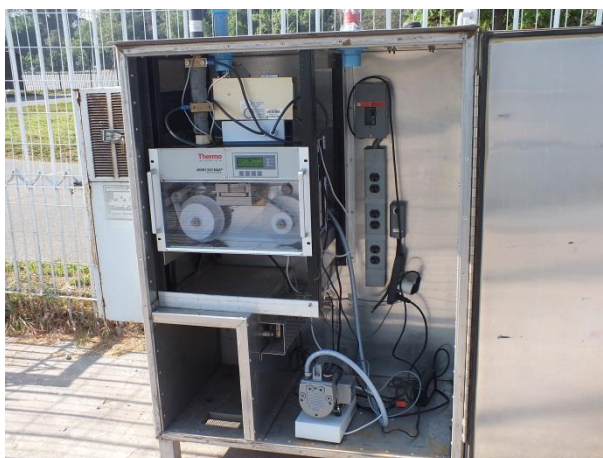
Figura 23: Equipo de monitoreo de Black Carbon - Multi Angle Absorption Photometer (MAAP) 5012, Thermo y equipo Espectrómetro Laser de Aerosoles, GRIMM.
