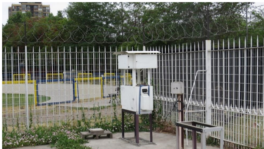
Figura 24: Equipo Low Vol, Partisol 2300-Speciation Sampler, Thermo.
